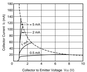
COLLECTOR CURRENT vs. COLLECTOR SATURATION VOLTAGE
